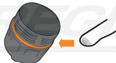
Тщательно нанесите качественную силиконовую смазку на уплотнительное кольцо.
