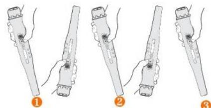
**Активировать:** наклоните пинпоинтер вверх и вниз, как на картинке, чтобы включить глубоководный режим (DM). Красный светодиод-индикатор будет мигать 2 раза каждый 3 секунды. Прибор готов к поиску.
