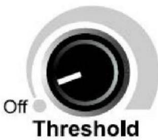
Эта настройка позволяет Вам регулировать уровень порогового тона, а так же включать и выключать Ваш металлодетектор. Когда ручка повернута против часовой стрелки до щелчка, Excalibur находится в состоянии "Выключено" (off). Если ручку повернуть до щелчка по часовой стрелке - Excalibur включится. Фон или
