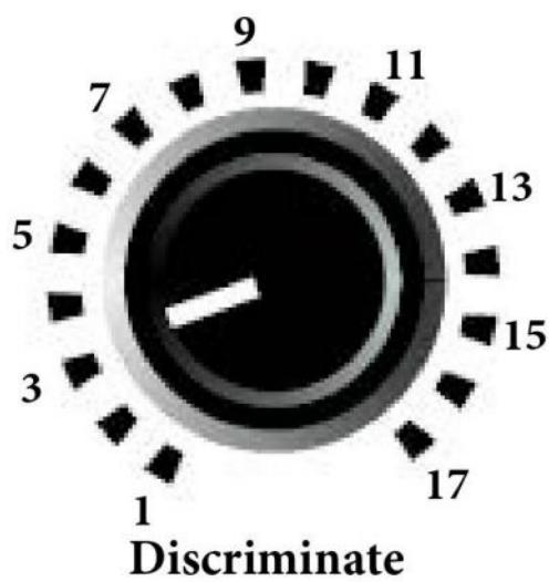
Эта настройка используется совместно с «Disc». Шкала позволяет определить, какие цели считать «ненежелательными». Если Ручка повернута так, чтобы ее риска совпадала с цифрой «1» Excalibur будет игнорировать железные цели. Большие железные цели могут производить короткие сигналы или "щелкать", однако, цветные цели дадут хороший сигнал.
