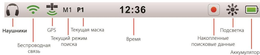
Рисунок 4 – Содержание строки состояния
