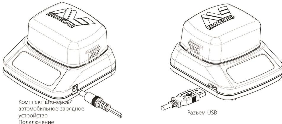
*Рисунок 36 – Разъемы BC 10 для адаптера и USB*
