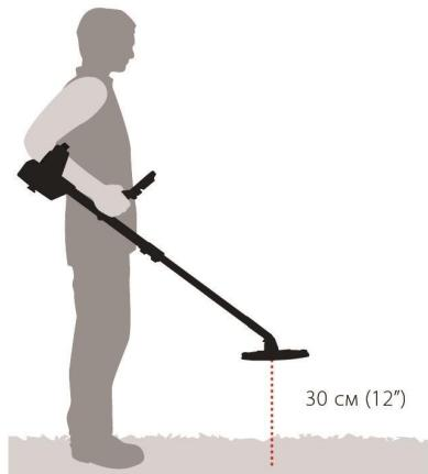
Рисунок 17 – Правильное положение детектора для отстройки от помех
