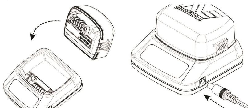
Рисунок 39 – Перезарядка литий-ионного аккумулятора
