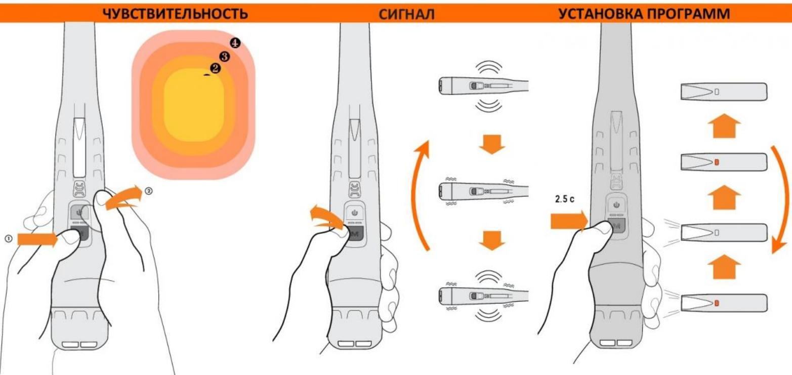
Когда прибор включен, нажмите и удерживайте кнопку режима, вместе с тем быстро нажмайтe кнопку включения, чтобы изменить уровень чувствительности с 1 до 4(максимально). На каждом уровне будет звучать дополнительный звуковой сигнал, а на уровне 4 он станет длинным.
