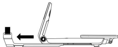
**ШАГ 4.** Сложите поисковую катушку, чтобы обнаружить параллель с землей (см. «Основные принципы работы с металлоискателем»). Зафиксируйте положение катушки, затянув гайку. Будьте осторожны, чтобы не затянуть гайку слишком сильно.
