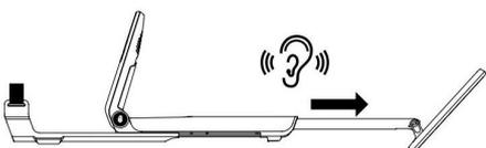
**ШАГ 6.** Отпустите рычаг поворотного замка, чтобы отрегулировать верхнюю штангу до необходимой длины с учетом вашего роста (см. «Основные принципы работы с металлоискателем»). Закройте рычаг поворотного замка, чтобы зафиксировать его положение.
