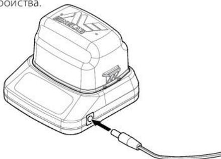
3. Подключите другой конец кабеля в розетку и включите переключатель или подсоедините к автомобильному прикуривателю. При использовании прямого соединительного кабеля сначала присоедините черный отрицательный (-) зажим к отрицательной (-) клемме аккумулятора, а затем красный положительный (+) зажим к положительной (+) клемме аккумулятора.
