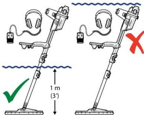
*Катушка GPZ 14 может быть погружена в воду на глубину до 1 м. Корпус металлоискателя и WM 12 не должны быть погружены в воду.*
