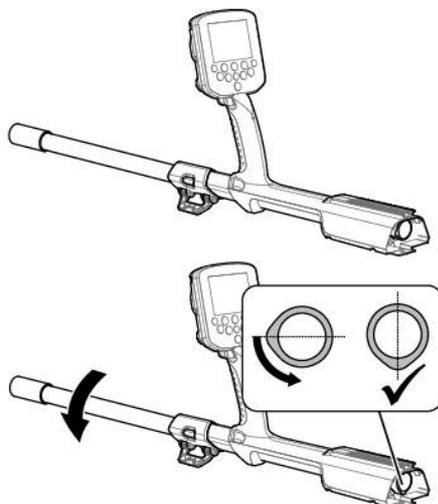
5. Зафиксируйте поворотный замок нажатием на рычаг по направлению к штанге.
