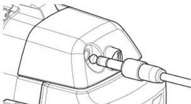
При использовании водонепроницаемых дополнительных наушников Вам нужно отсоединить модуль для наушников от блока управления и подключить наушники к открытому разъему для наушников, не забыв затянуть крепежные кольца.
