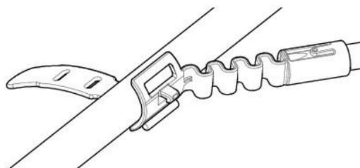
2. Оберните ремень вокруг штанги и перекрутите конец ремня через паз гибкого соединения. Затяните ремень, пока крючок гибкого соединения не пройдет через первый паз на ремне.
