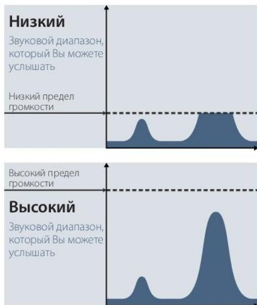
Слышимость сигнала с разными настройками уровня порогового тона
