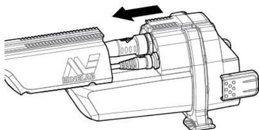
2. Присоедините катушку и кабели панели управления к соответствующим разъемам и надежно затяните крепежные кольца.
