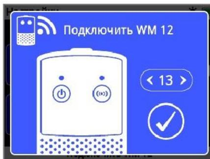
Последовательность действий подключения WM 12, показывающая выбор канала
