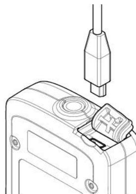
2. Подключите другой конец USB-кабеля к зарядному устройству BC 10 или непосредственно к USB-порту на Вашем компьютере.
