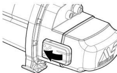
2. Установите модуль для наушников в блок управления. С помощью отвертки или монеты аккуратно затяните болт, стараясь не повредить резьбу в результате чрезмерного натяжения.
