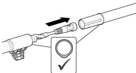
4. Зафиксируйте поворотный замок нажатием на рычаг по направлению к штанге.
