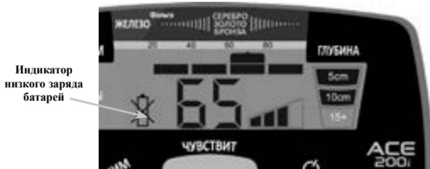
Включается при низком уровне заряда батарей. Металлоискатель сохраняет рабочие функции, но после включения индикатора необходимо выполнить замену батарей. Могут использоваться перезаряжаемые батареи NiMH, хотя такие батареи отличаются меньшим временем действующей зарядки. Батареи, в зависимости от типа и качества, обеспечивают от 20 до 40 часов эксплуатации металлоискателя.
