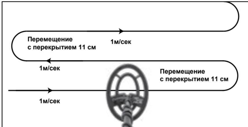
Для полного обследования участка поиска каждый последовательный взмах катушки должен перекрывать предыдущий на половину длины катушки (около 11 см). Перемещайте катушку по прямой линии или по небольшой дуге со скоростью около 1 м/сек.
