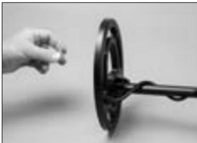
Определившись со способом регистрации объекта поиска, выполните несколько испытаний оборудования на грунте. Создайте "пробный участок" поисков, закопав несколько металлических предметов на определенной глубине.
